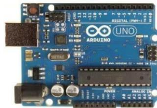
**Gambar 2.2. ARDUINO UNO ATMEGA 328[7]**
